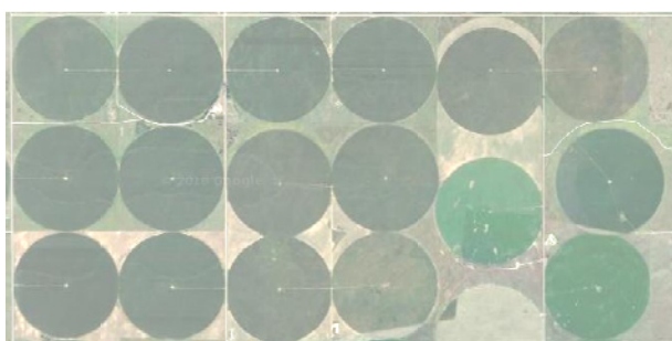
Рис. 2. Космическая фотография круглых полей. Участки круглой формы – орошаемые с помощью дождевальных машин поля, участки между кругами – необрабатываемые
