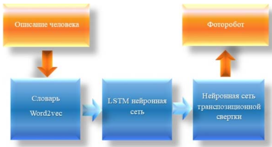
Рис. 2. Блочное представление системы построения фоторобота по словесному описанию
